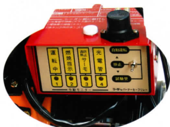
▲モニター付バーコンリレー 上部の黒い部品は感震センサー
