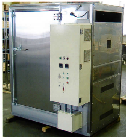
▲薬品原料乾燥炉(電気式)
