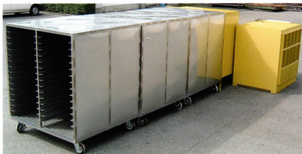
▲台車連結式乾燥機(ガス直火式)
